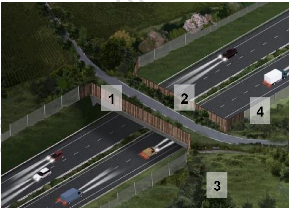
Abbildung 127 Beispiel einer oberirdischen Querung für Fledermäuse (begrünte Brücke mit Fuß- und Radweg über die B 269)
